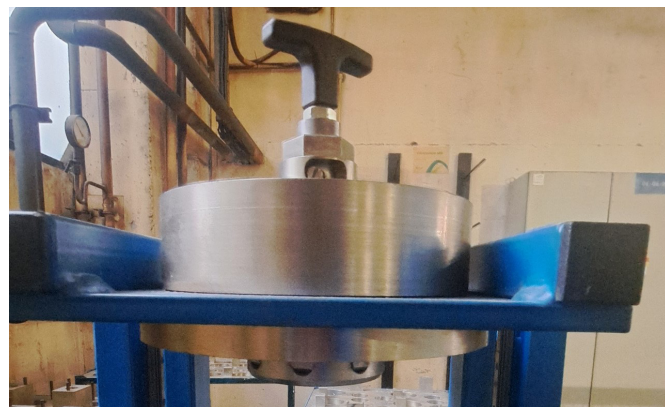
Obr. 3 Upínací prípravok upevnený na manipulačnom vozíku
